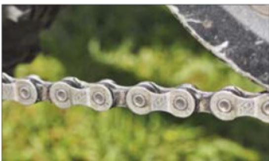
testování. Další měření na kilometru 650 ukázalo protažení na 132,5 a speciální měrka od BBB na hodnotě 75 % stále nezapadla mezi články. Po další dvoustovce kilometrů pak měrka sice zapadla zobáčkem s hodnotou 75 %, ovšem druhý zobáček s hodnotou opotřebení 100 % držel na článku a nezapadal ani při působení silou. Měrka pak na této kilometráži ukázala 132,7 mm, takže ještě dostatečná rezerva pro další stovku až dvě, kdy bychom řetěz vyměnili.
