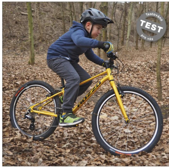
rámová trubka má nezvykle nízký obdélníkový profil a vstupuje do ní zespodu bovenad zadní brzdy. Spodní trubka je naopak kruhová s lehkým prohnutím za hlavou a opět vnitřním vedením bovdenu, prakticky taženého v jednom kuse až k přehazovačce. Rám tudíž vypadá čistě, ale současně je vedení kabeláže maximálně praktické.
