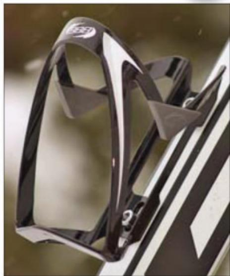
dence bidonu k vysouvání z košíku ven. Toto řešení i přes houževnatost materiálu a pevné uchycení bidonu doporučujeme spíše na silnici, kde bude výhodou i celková hmotnost pouhých 22 gramů.
