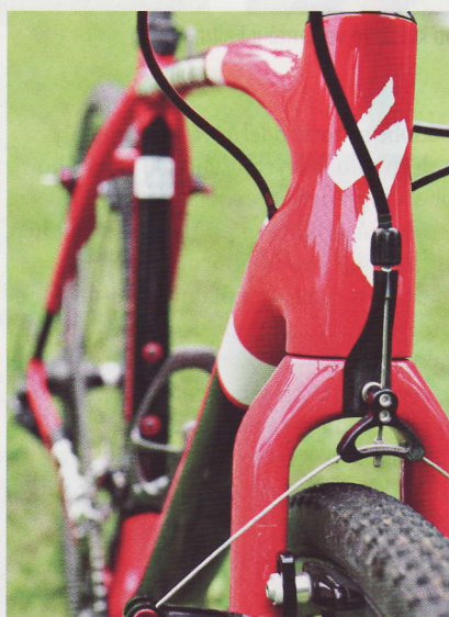
Hlavová trubka s rozdílnými průměry ložisek v podání Feltu a Specializedu.
