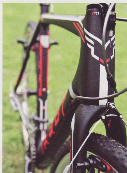
Hlavová trubka s rozdílnými průměry ložisek v podání Feltu a Specializedu.
