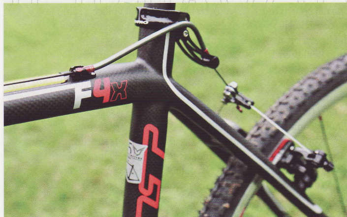
Vnitřní vedení lanka zadní brzdy v podání Cruxe oproti klasické variantě u Feltu.
