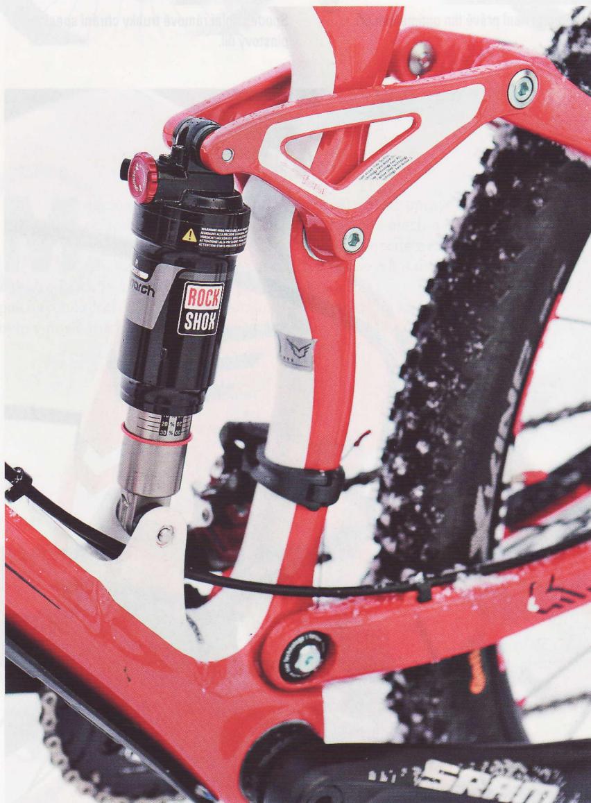
Designově zajímavá je sedlová trubka s výraznými rozšířeními pro umístění čepů, jen uchycení přesmykače vyžaduje objímku.
